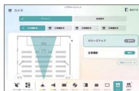
⑥カメラ操作 カメラのプリセット操作やパン・チルト・ズームの微調整を行います。
