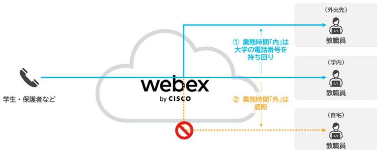
図. クラウドによる電話の集中管理イメージ(例)
