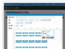
授業時間に合わせて自動で機器のON/OFFができます。授業時間に合わせて自動で機器を立ち上げることができ、余分な時間が削減されます。教室毎の終了時刻に合わせて、機器の電源OFFが行え、つけっぱなしによる動作不良を防げます。
